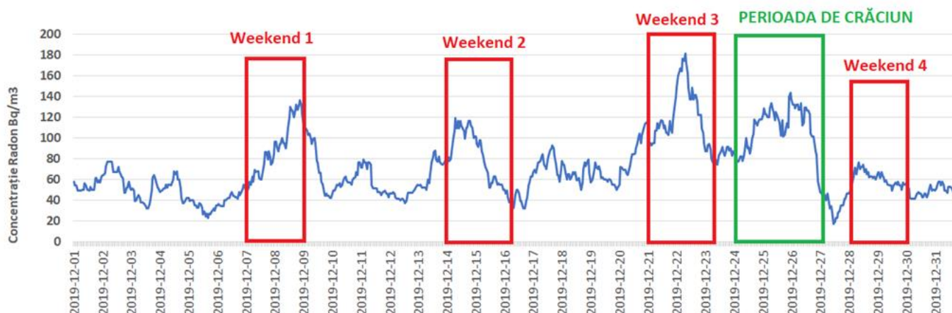
Fig. Nr. 1: Fluctuația concentrației activității de radon în funcție de zilele lucrătoare ale săptămânii
