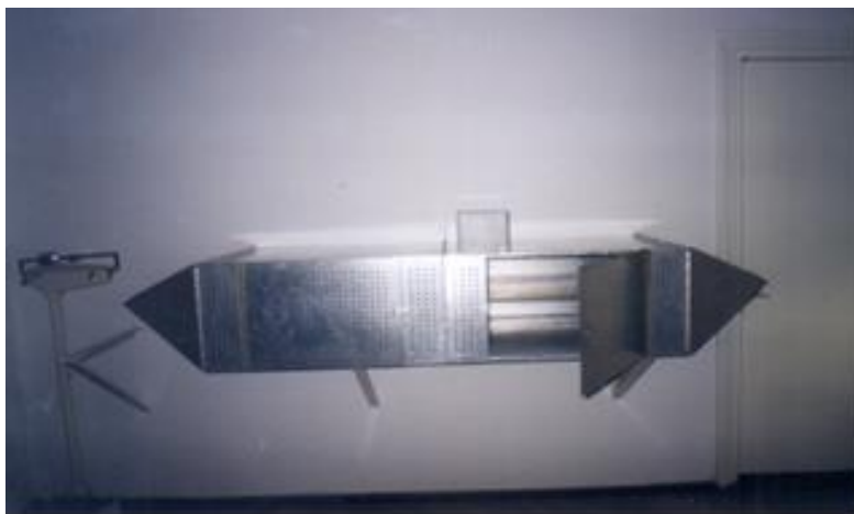
Fig. 1. Instalație de expunere controlată la CEM de radiofrecvență de tip celulă TEM, proiectată și construită la Iași [14].
