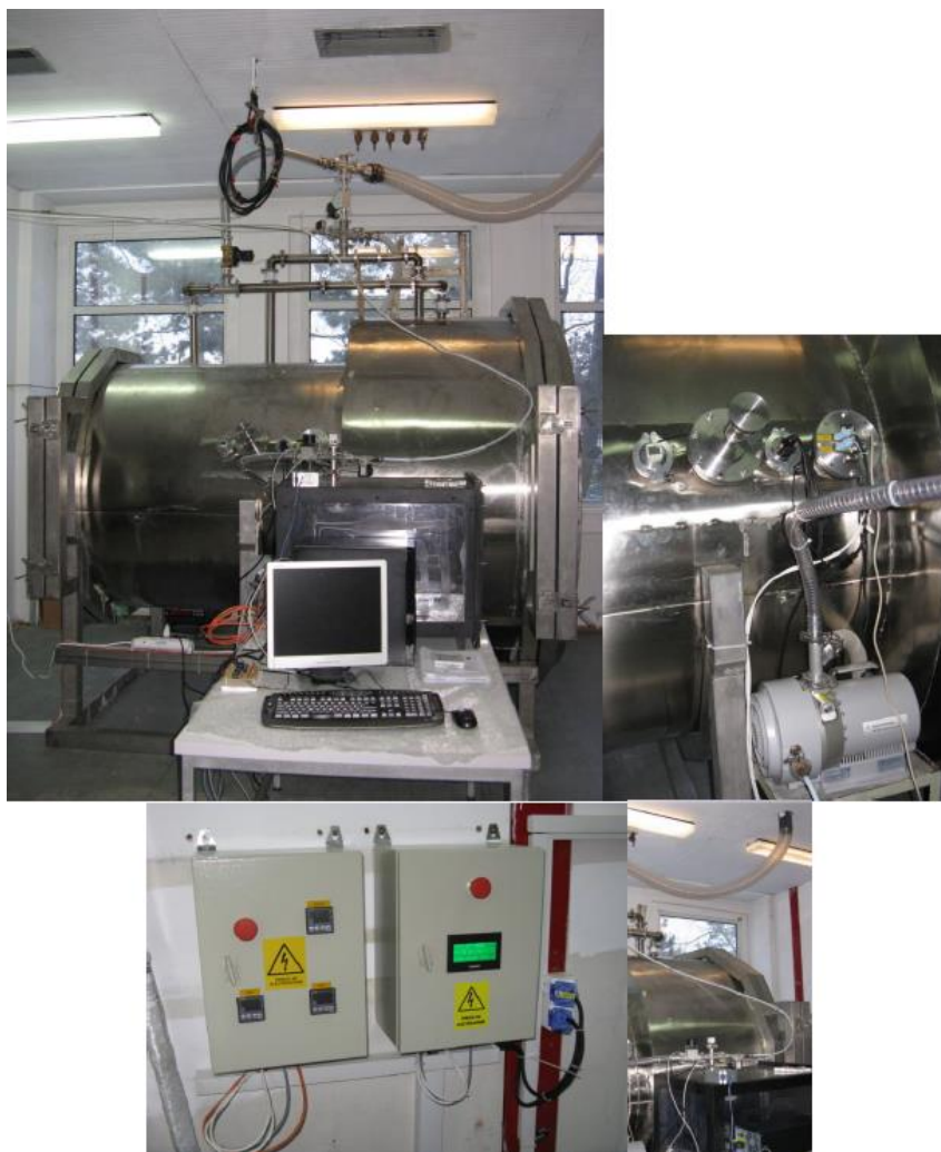
Figura 5 – Camera de Radon din cadrul IFIN HH [27]
