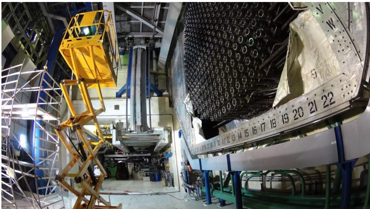
Figura 1a - Se poate observa ca detectorul este amplasat pe nacela, comenzile către sistemului de achiziție fiind transmise de la distanță (zona cu debite de doză mici)
