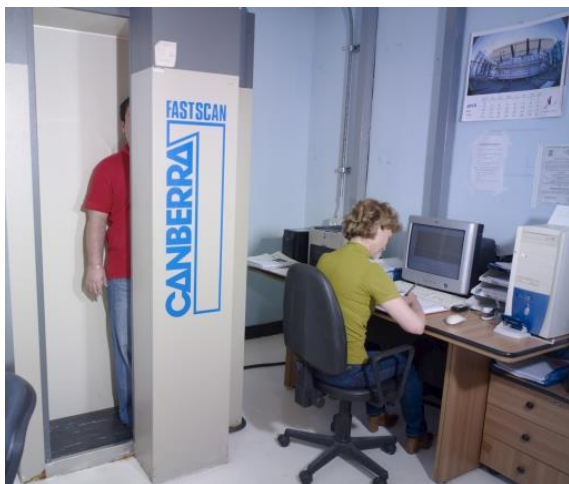
Figura 2 - Contor de Corp Uman FASTSCAN și ACCUSCAN II - CNE Cernavodă
