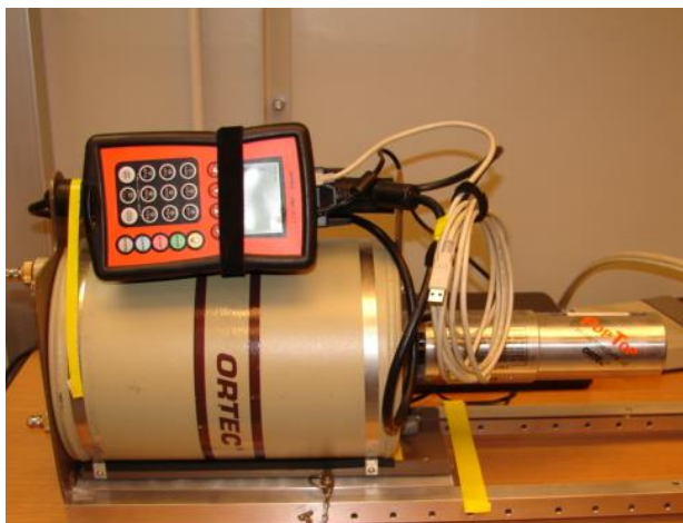
Figura 1 - Sistem \gamma -spectrometric ORTEC HpGe (cu detector de germaniu hiperpur)
