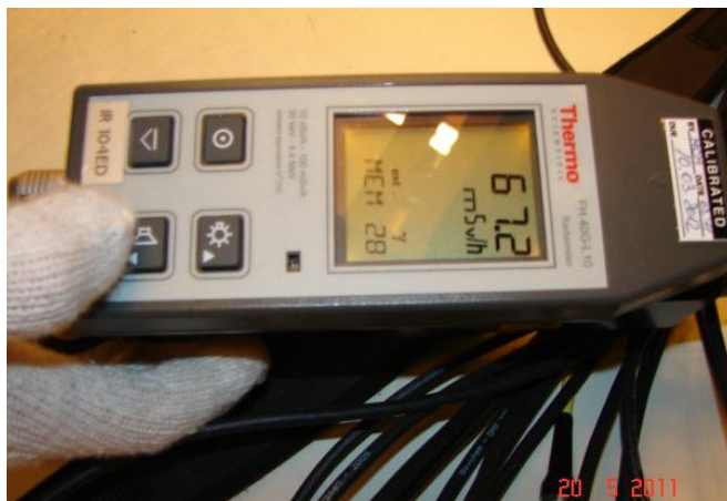
Fig. 4 - Identificare hot-spot în camera Generatorului de Abur GA # 1, Unitatea 2, 2011
