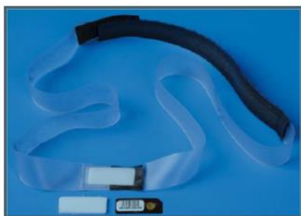
Figura 2: Dozimetrul și bentița Harshaw / Thermo EXTRAD
