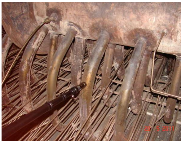
Fig. 2 – debitmetru \gamma FH40GL-10 (cu sonda FHZ 632L)
