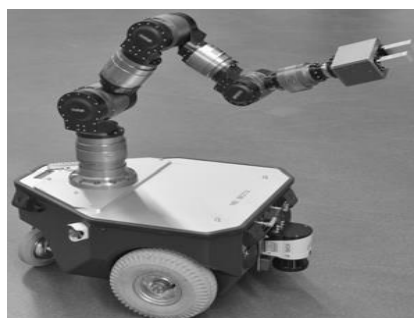
Figura 11: Braț robotic decontaminare [13]
