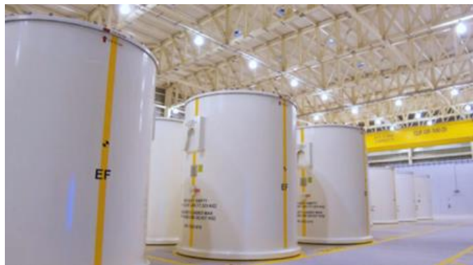
Figura 6 Containere de depozitare a deșeurilor mediu radioactive de la retehnologizarea Unității 2 Darlington [6]
