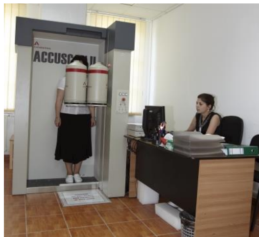
Figura 2 - Contor de Corp Uman FASTSCAN și ACCUSCAN II - CNE Cernavodă
